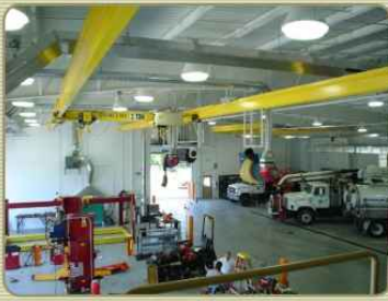
Hệ thống monorail (Tải trọng đến 20T, đường chạy bất kỳ...)
