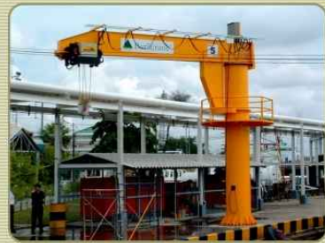
Cầu quay, cầu tường (Tải trọng đến 10T, tầm với đến 10m)
