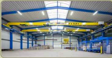
Cầu trục dầm đơn (Tải trọng đến 20T, khẩu độ đến 30m)
