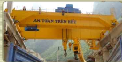
Cầu trục dầm đôi (Tải trọng đến 320T, khẩu độ đến 30m)
